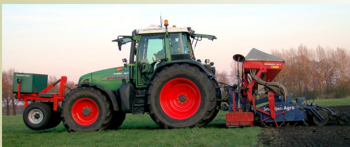
Trekker van Wijnand Snoeijen met zelfsturend rtk-gps systeem. Deze machine stuurt met 2cm precisie over het veld
