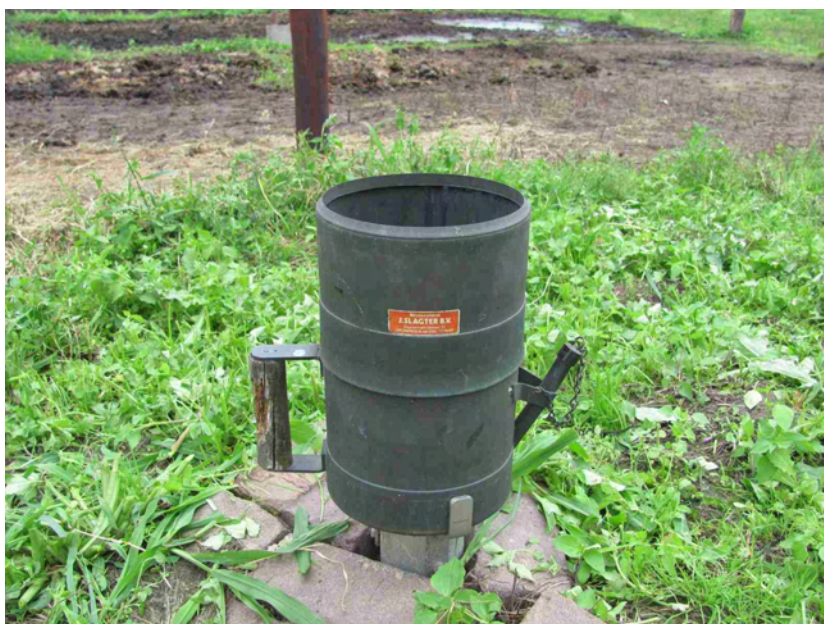
De regenmeter van het KNMI op Leenderstrijp. Iedere dag wordt om 10 uur de hoeveelheid neerslag door de familie Bax op de Zandberg doorgegeven aan het KNMI. Aan de bovenzijde de trechter, daaronder het reservoir met rechts de uitschenk opening.
